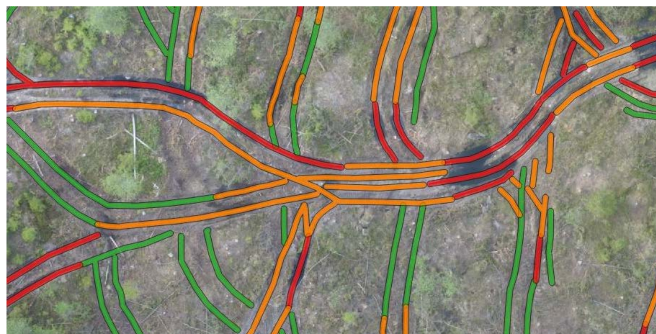
Figur 2: Spordybde måling med laser under skogsdrift
