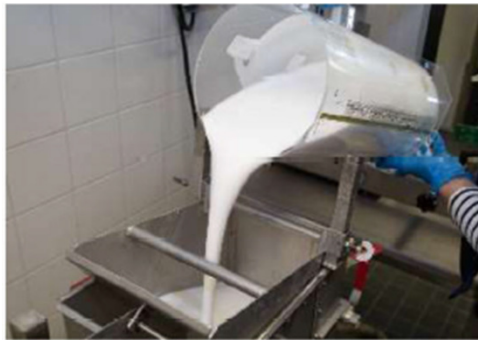
Overføring til kammer med avvanning
